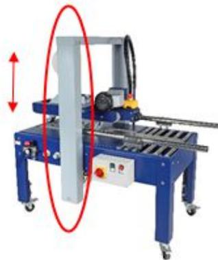
**Il est possible de faire varier mécaniquement la hauteur du pont supérieur sur trois positions différentes. Cette option permet d'avoir des hauteurs minimum et maximum des cartons différentes du standard**
