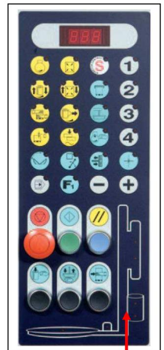
Synoptique avec LED rouge pour signaler sur la machine l'emplacement d'un défaut en cas de panne . Afficheur lisible pour affichage des valeurs de réglages et des codes d'erreurs éventuels
