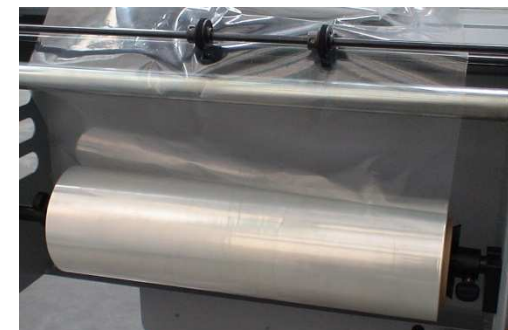
changement de bobine rapide et perforation escamotable
