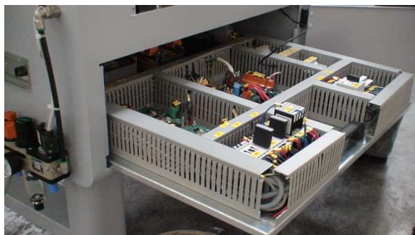
Tiroir escamotable de toutes les cartes électroniques Intervention et maintenance nettement facilité
