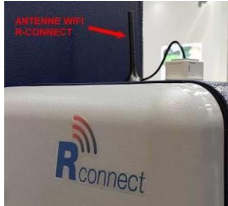
L'option R-CONNECT peut être installée directement sur la machine ou intégrée ultérieurement. En fait, les machines Robopac sont déjà configurées pour installer une passerelle spéciale qui envoie toutes les informations en temps réel, en la rendant disponible dans le Cloud, avec des statistiques qui peuvent ensuite être utilisées via une simple connexion Internet depuis n'importe quel périphérique (PC, tablette, smartphone, etc.).
