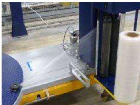
Système de réduction de laize pneumatique ( alias ROPING => lien vidéo : [ROTOPLAT 508 PDS avec ROPING](#)).
