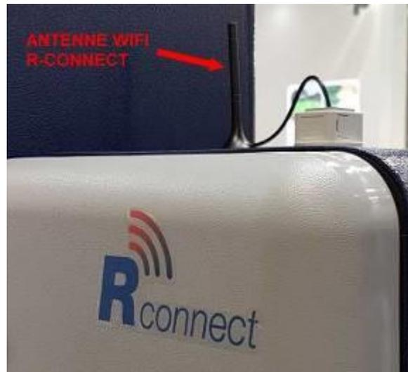
L'option R-CONNECT peut être installé directement sur la machine ou intégré ultérieurement. En fait, les machines Robopac sont déjà configurées pour installer une passerelle spéciale qui envoie toutes les informations en temps réel, en la rendant disponible dans le Cloud, avec des statistiques qui peuvent ensuite être utilisées via une simple connexion Internet depuis n'importe quel périphérique (PC, tablette, smartphone, etc.).
