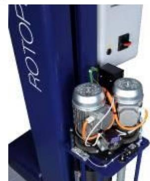
réglage de la force de dépose pour assurer une tension du film constante. Cette fonction est indépendante de la fonction pré-étirage.
