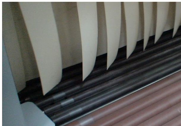
OPTION : Tapis rouleaux mobiles téflonnés
