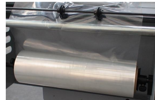
changement de bobine rapide et perforation escamotable
